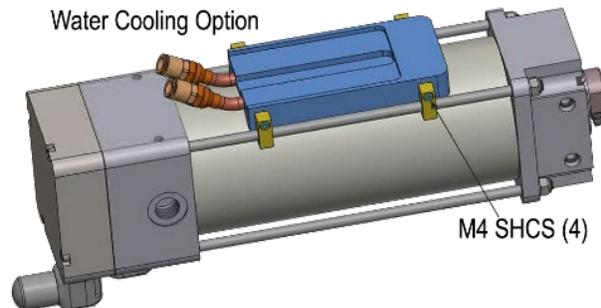
Abbildung 4.6: Untersicht von SWA & SWB mit angebaute Wasserkuhlungsoption
