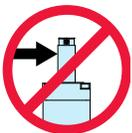
Eine übermäßige seitliche Belastung der Ausgangsschubstange des Aktuators verringert die Lebensdauer des Aktuators drastisch und sollte vermieden werden. Eine seitliche Belastung kann durch eine falsche Ausrichtung oder eine Belastung verursacht werden, die nicht in einer Linie mit der Ausgangsschubstange des Aktuators liegt.
