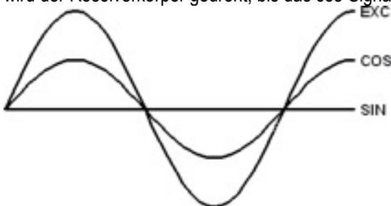
Abbildung 5.5: Motor-Drehlage bei 0
