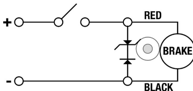
Abbildung 6.2: Erhöhte Ein- / Auskuppelzeit, bester Schutz
