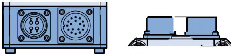
Abbildung 5.3: Zeichnung der bei einigen ServoWeld-Aktuatoren verwendeten Einbaustecker.
