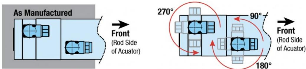
Abbildung 5.2: Steckerdrehung. Beachten Sie, dass die Tolomatic-Standardstecker von  $-90^\circ$  bis  $+180^\circ$  gedreht werden können, so dass die Kabel zur Vorderseite (Stangenende, wie hergestellt), zu einer Seite, zu beiden Seiten oder zur Rückseite des Aktuators angeschlossen werden können.
